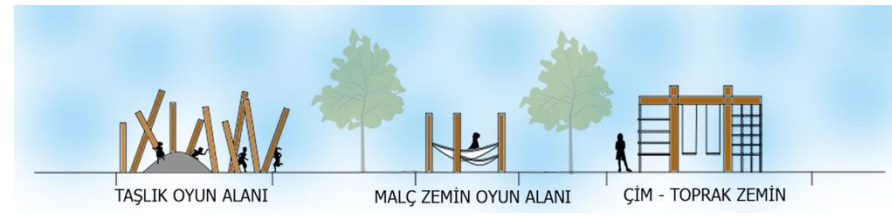
Şekil 5.5. Farklı Zemin Malzemeleri ve Oyuncaklar
